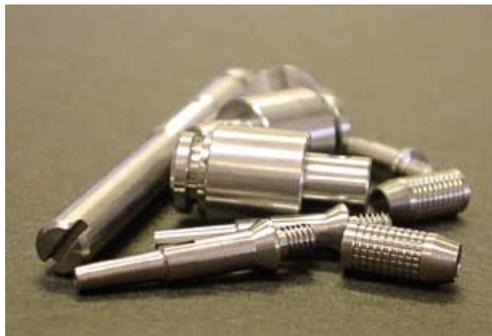
バリ取り剤で洗浄処理した金属部品の一例
