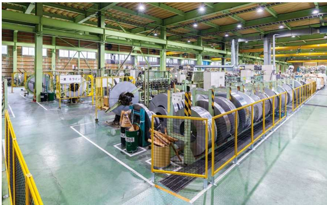
今回5S活動を行った第一工場内の全景。白線引きや安全柵の設置も行った。
