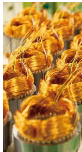
モーターコイルをセットする作業。時間と手間のかかる作業をいかに効率化するかが改善提案の肝になりました。
