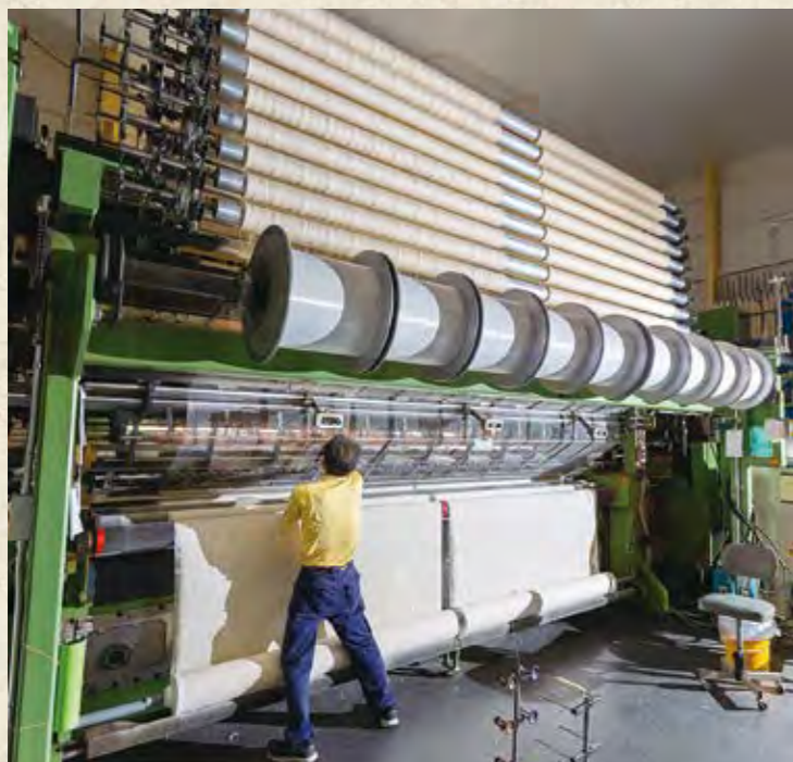
「andante」の編み機。 日本に2台しかない1987年製ラッセルレース編み機を、独自にカスタマイズしている。
