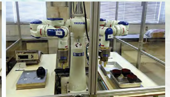
双腕ロボット(二本の腕で人間の作業を再現可能なロボット)
