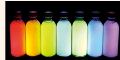
(上)屋根・雨漏りに携わり70年以上経ちます。 (下)紫外線照射での色付き発光によって、 漏れの経路を特定。
