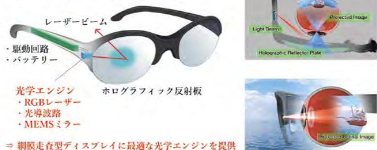
⇒ 網膜走査型ディスプレイに最適な光学エンジンを提供 超小型光学エンジンを搭載したスマートグラスのイメージ図
