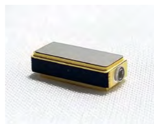
光導波路を使った新しい光合波技術により実現した、4.8mm×11mm×3mmという世界最小サイズの超小型光学デバイス。
