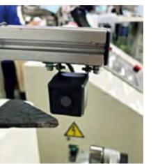
そのほかの改善例。中腰での作業による負担軽減のため、カメラを設置。卓上ディスプレイで長さを確認できるように。
