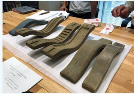
軽量化を図るため裏面の削り方を検討。金具を含め、試作を繰り返しました。
