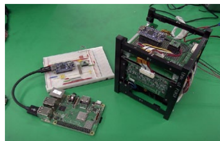
動作確認用回路(左)と衛星に搭載した回路
