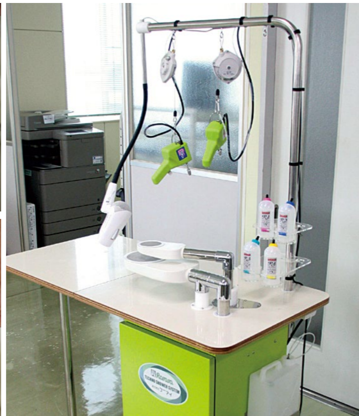
同社のしみ抜き機のひとつ。クリーニングガンを吊るすバランスー等、作業者の身体的負担を軽減する工夫が。
