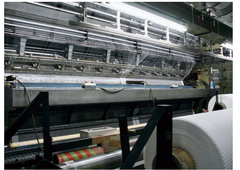
緯糸挿入の経編機。国内でも数少ない機械となっている。
