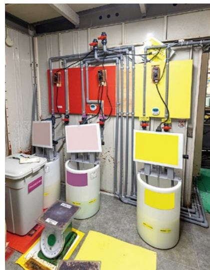
石川氏が自作したかくはん機。以前は手作業で混ぜていた。
