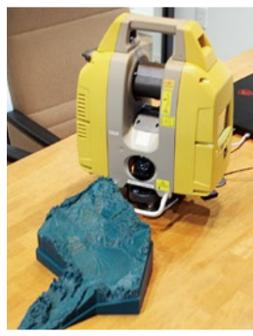
今回導入したレーザースキャナー。ドローンの使用できない現場に3次元測量を可能に。
