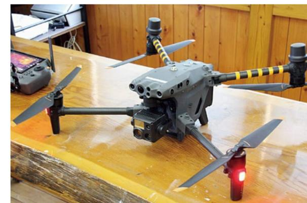
同社が導入したドローン、赤外線カメラも搭載している。
