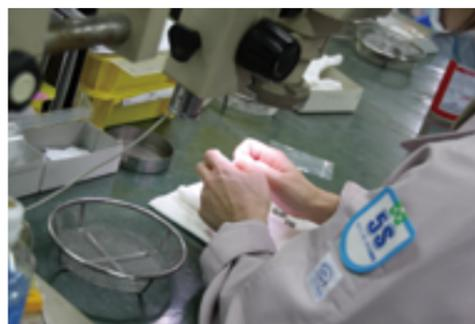
約3ミリの極小部品もあり、バリ取り作業は顕微鏡を使って慎重に行います。部品の最終検品も人の目で慎重にチェック。品質管理に万全を期しています。
