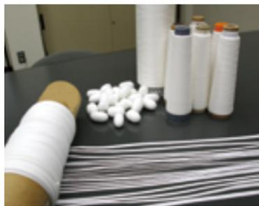
絹製の人工血管。筒状にして使われます。
