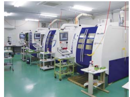
工場内写真 エンドミル等の刃付け加工
