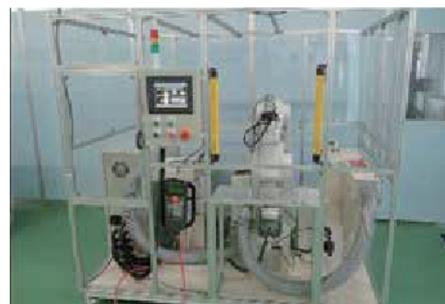
(写真1) 導入した6軸垂直多関節型ロボット
