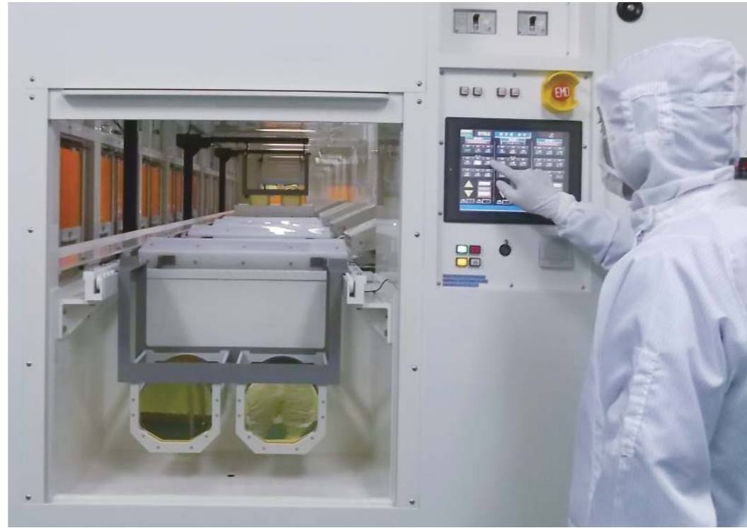
半導体シリコンウエハへのめっき技術。高い精度で不良品率を限りなくゼロにしています。
