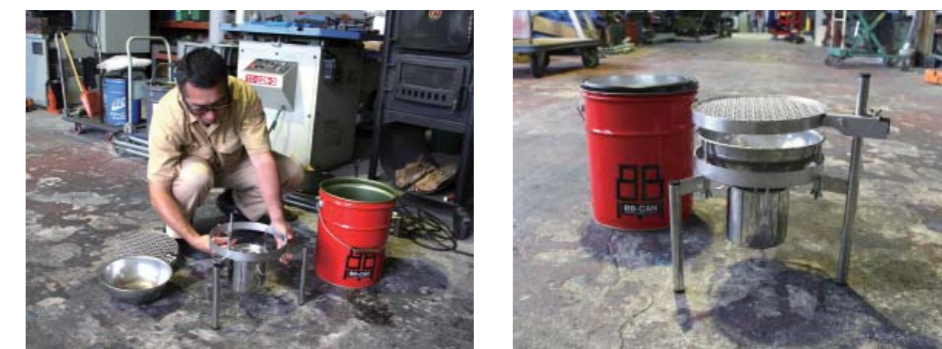
BB-CANを組み立てる田安氏。1分足らずでセット完了です。
