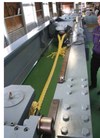
新しく導入した強度試験機。600KNまで測定できる業界日本一のもの。
