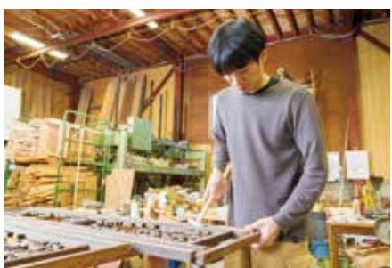
オーダー家具を手がける山口氏。古民家で使われていた欄間をテーブルにリメイクする様子。
