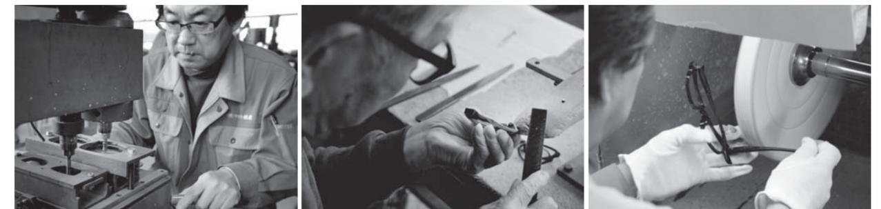
現在も受け継がれる職人技。一番難しい工程の「磨き」（写真右）がセル枠の持ち味を引き出します。
