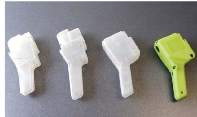
クリーニングガン持ち手部分の試作品と完成品(右) 試作の度に改良され、完成型に近づいています。
