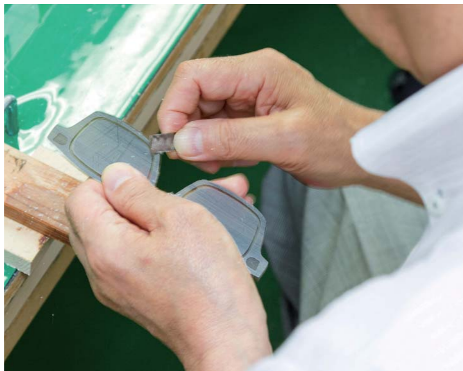
糸鋸で切り出したフロントの角やバリなどを、やすりをかけて取り除く作業。力の入れ方を加減し、なめらかに削るのがコツだそう。体験者からは、「楽しい!」、「夢中になる!」などの声があがっていました。
