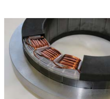
らせん状に巻かれたコイルの様子
