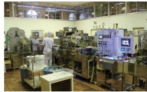
昆布独特の節状の部分が入り込んでいないか、工程の途中に独自に開発した「厚みセンサー」を取り付け、品質管理を徹底しています。（青白く見える箇所）
