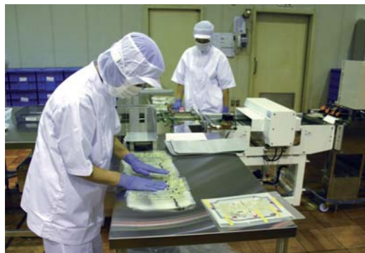
2台の包装機で、1日6万枚の生産が可能。スタッフが一枚一枚フィルムを目視して、割れなどを最終チェックします。
