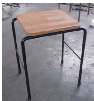
ワークショップで製作されたスツール。鉄の棒から、曲げと溶接で形になっています。
