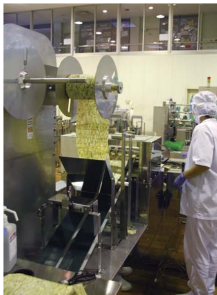
全国初のコンビニおにぎり専用おぼろフィルム原料送り込み装置。『昆布シート』が割れることなく、スムーズに流れていきます。
