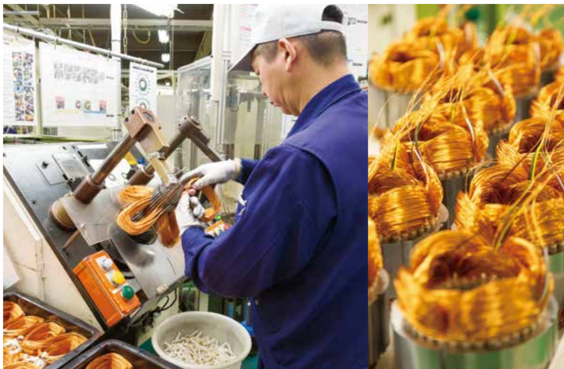
モーターコイルをセットする作業。時間と手間のかかる作業をいかに効率化するのが改善提案の肝になりました。
