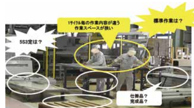
現場改善提案資料より。細かな改善点が洗い出されました。
