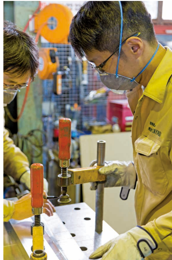
溶接部材を固定する作業。協力し合いながら進めます。
