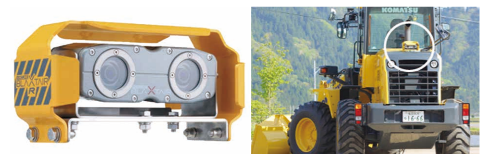
人と物を見分けるインテリジェント・カメラ・システム「ブラクステール」。歩行者との接触の危険があるときだけ、警告を発します。
