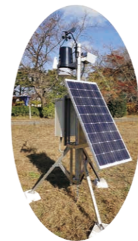
福島県で導入されている緊急対応型気象観測装置とシステムのモニター画面。傾斜計や水位計などと組み合わせ危険箇所を設置することで、土砂崩れなどの災害予測に利用可能です。
