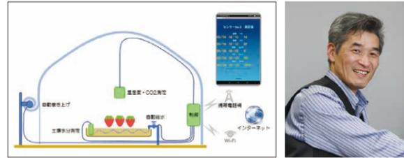
ビジネス界を騒がすキーワード「IoT(Internet of Things)」。その流れにいち早く乗り出し、独自システムの開発に踏み出した山本氏。目を付けたのが農業×IoT。これまでにない効率的でスマートな新しい農業を目指します。第一弾として完成させた『Ho-SaKU』はビニールハウス内の環境制御をする総合システム。ハウスの温度や湿度、CO2濃度などを測定し、その情報がいつでもスマートフォンで確認できるというものです。カーテン自動巻き上げ機能も付けられ、「ハウスの温度が気になって遠出もままならない」という農家の悩みを解消してくれます。実証テストを繰り返し、より良いシステムを目指し日々邁進しています。
