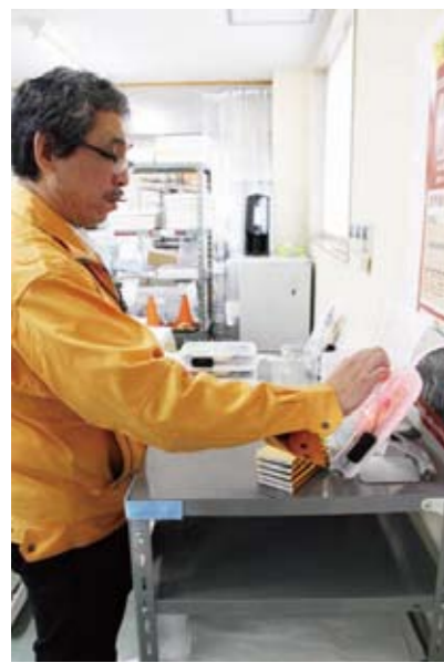
汎用品を組み合わせ自社独自にカスタマイズしたRFIDリーダーシステム。ピンクの部品(クリアファイル)をバラした中に見える白いシートがRFタグ。個人や作業のデータが組み込まれています。
