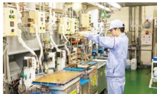
メッキ作業の様子。これまでよりも重くなったパッチに対応し、パッチ上部にハンガー(持手)を取り付け、作業の安全性がアップしました。
