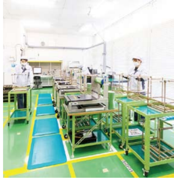
・検査室内のパーテーションを取り払い、スペースを拡張。これまで製品が占拠していた通路を広く確保し、作業者が交差しない動線に。(写真左・中) ・運搬台の上での治具付け作業。運搬台はキャスター付き(写真左参照)で、重いパッチの載せかえが不要になり負担が減りました。(写真右)
