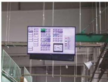
サーシステムを設け、織る前に糸の汚れや欠陥を把握できるようにしました。工場では全織機をモニタリングし、機械の稼働状況や経糸と緯糸の消費量、糸切れや機械の部品交換などのトラブルも、すべてリアルタイムで監視・記録が可能になりました。
