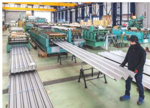
屋根材は1形状1ラインの機械で成型する。
