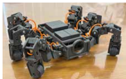
ほとんどを3Dプリンターで作るパーツで組み立てた試作ロボット
