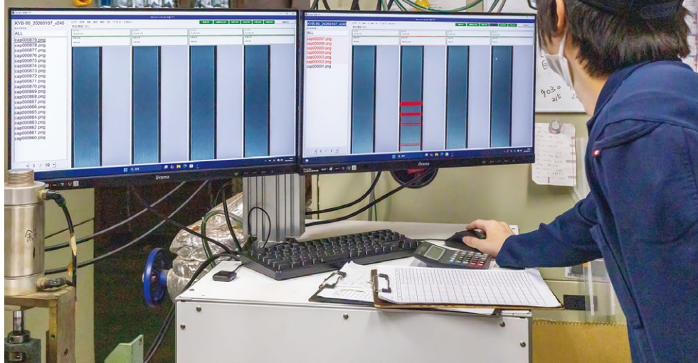
モニター上に不良箇所が赤色で示される
