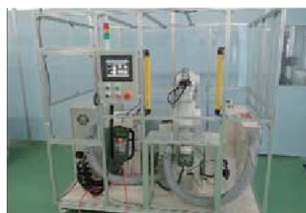
(写真1) 導入した6軸垂直多関節型ロボット
